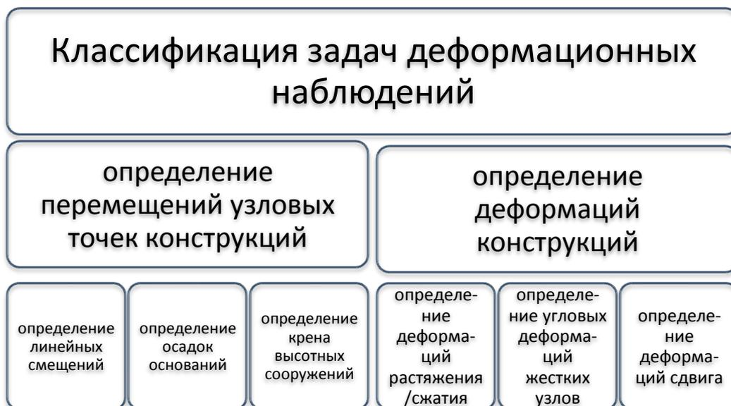
Рис. 1. Классификация задач деформационных наблюдений
